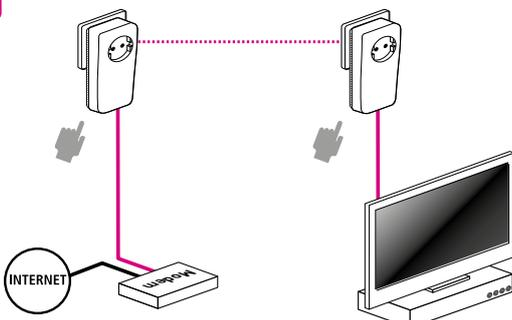
Afin de sécuriser le flux Internet au travers de votre réseau électrique, vous devez appuyer sur le bouton qui se trouve à côté des prises Ethernet de votre adaptateur CPL. Veuillez appuyer sur le bouton d'un adaptateur CPL et ensuite sur le bouton du second adaptateur. La manœuvre doit être réalisée dans un laps de temps de 2 minutes maximum. Votre branchement est terminé.
