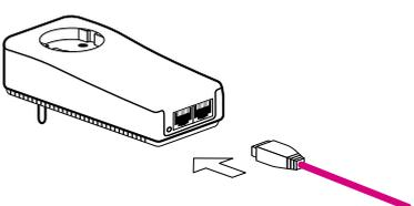
Connectez le second câble Ethernet fourni avec le kit à au second adaptateur CPL.
