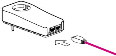
Connectez le câble Ethernet fourni avec le kit à l'adaptateur CPL.
